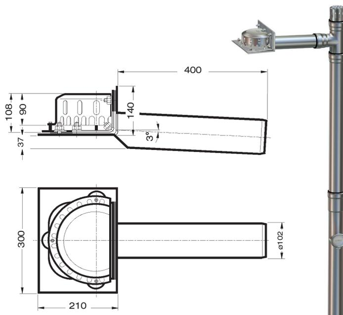
**Schiebeflansch für LORO-Attikadirektabläufe**
